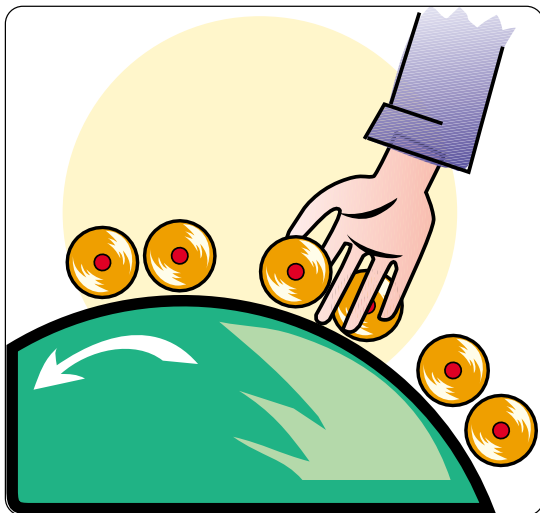
Impigliamento e trascinamento con il tamburo garzatore.
