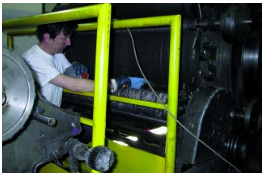
Figura 4 - Taglio e rimozione fasciatura muovendo la macchina con la pulsantiera
