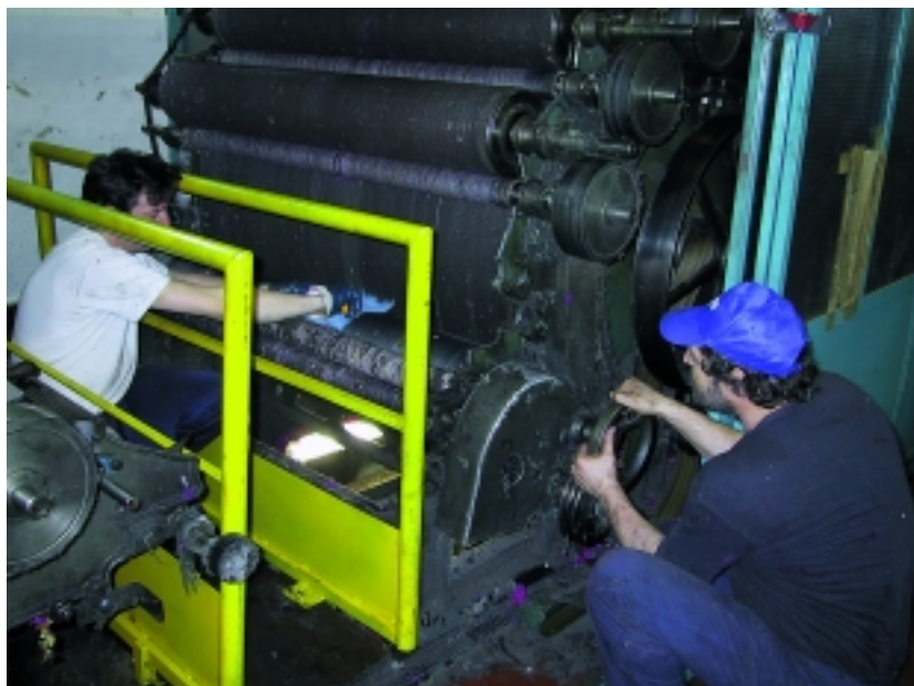
Figura 1 - Ruotatura a mano del rubano e taglio della rolla con taglierino
