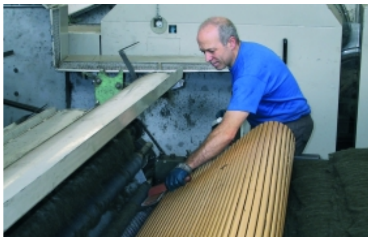
Figura 3 - Pulitura con spazzola dei cilindri ingollini a macchina ferma
