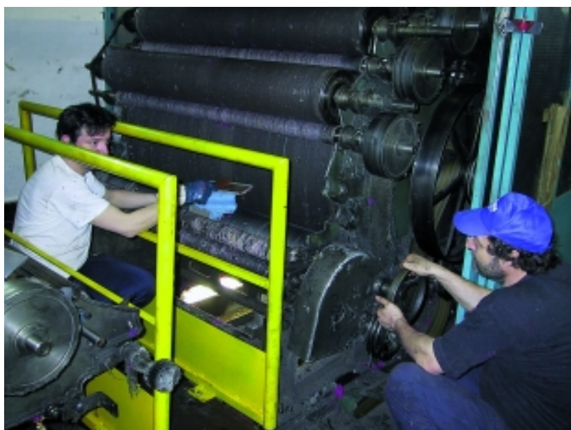
Figura 2 - Ruotatura a mano del rubano e pulitura con spazzola
