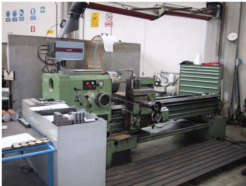
Figura 4 – Manicotto con dispositivo di blocco che circonda il mandrino in posizione di lavoro
